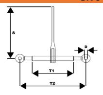
Ratschenlastspanner - mit Ausdrehsicherung und mit 2 Ösen
